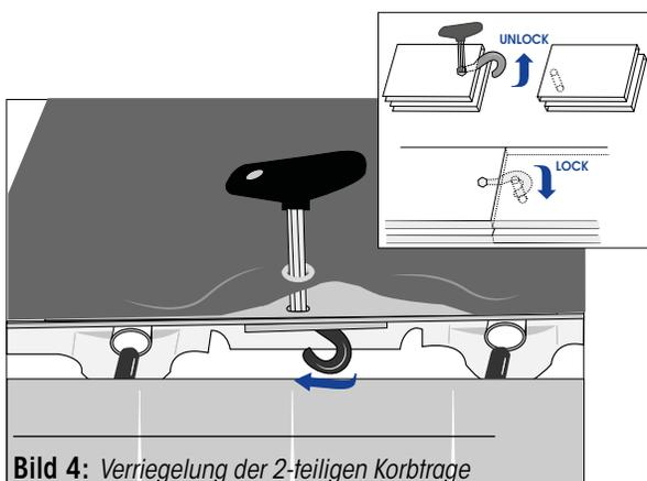
**Bild 4:** Verriegelung der 2-teiligen Korbtrage
