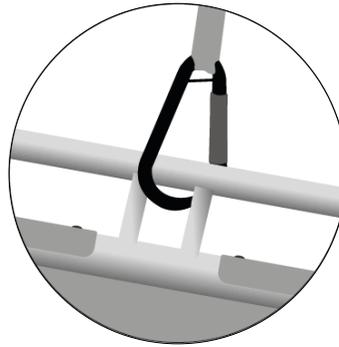
**Bild 3b:** Befestigung direkt am Metallrahmen
