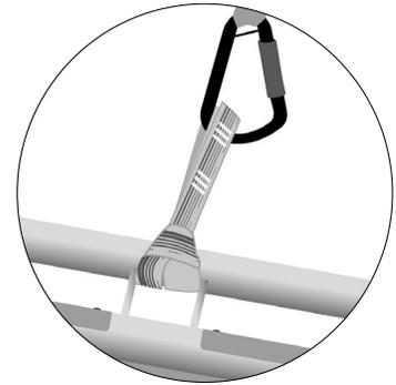
**Bild 3c:** Befestigung mithilfe der Bandschlingen
