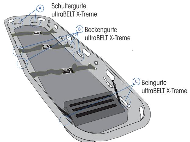
**Bild 6:** Teile des Gurtsystems ultraBELT X-TREME
